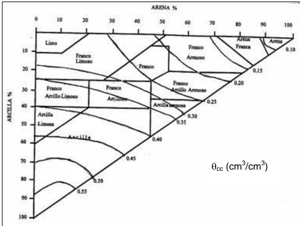
TRIÁNGULO PARA DETERMINAR EL CONTENIDO DE HUMEDAD A PUNTO DE MARCHITAMIENTO PERMANENTE
