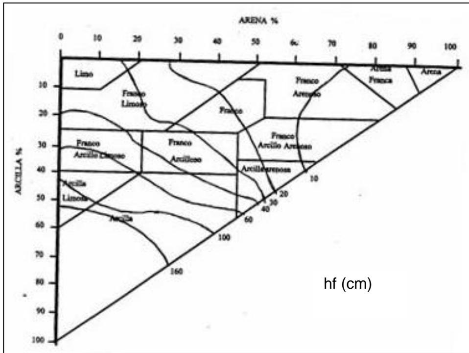
TRIÁNGULO PARA DETERMINAR LA CONDUCTIVIDAD HIDRÁULICA A SATURACIÓN (Ks, cm/h)
